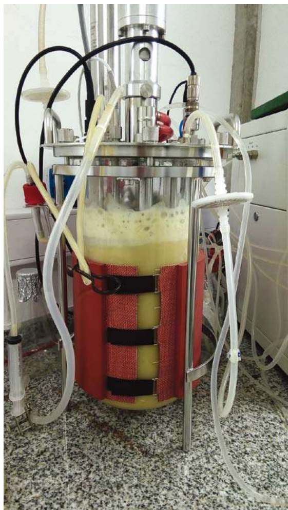
Figura 3: Biorreactor de 5 litros para cultivo de procariotas, hongos y levaduras: BIOSTAT® en operación
