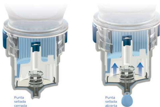
Figura 3: El mecanismo de punta sellada utilizado en el Ophthalmic Squeeze Dispenser, exclusivo de Aptar Pharma, es estrictamente mecánico.
